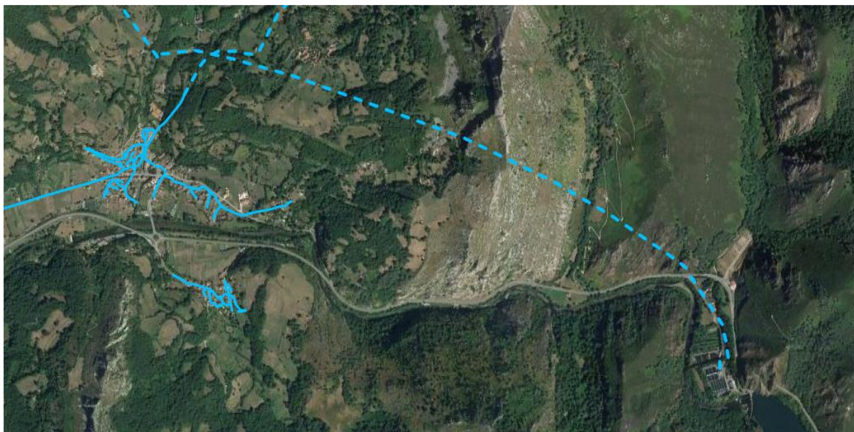
Ilustración 2. Distribución de CADASA desde la E.T.A.P. de Rioseco (línea discontinua) y suministro (línea continua) en El Condado.
